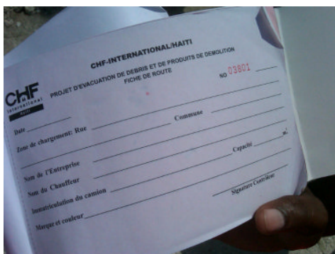
Fiche de contrôle utilisée pour vérification indépendante du volume de gravats déblayés
